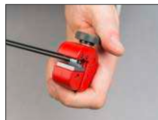
Posicionamento da tubagem para raspar o revestimento
